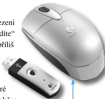
Optická myš, jejíž komunikace s počítačem je řízena bezdrátově pomocí USB adaptéru
